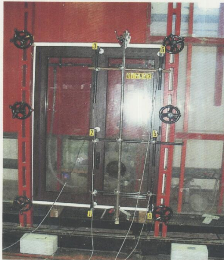
Foto 1: Schema di applicazione dei trasduttori
